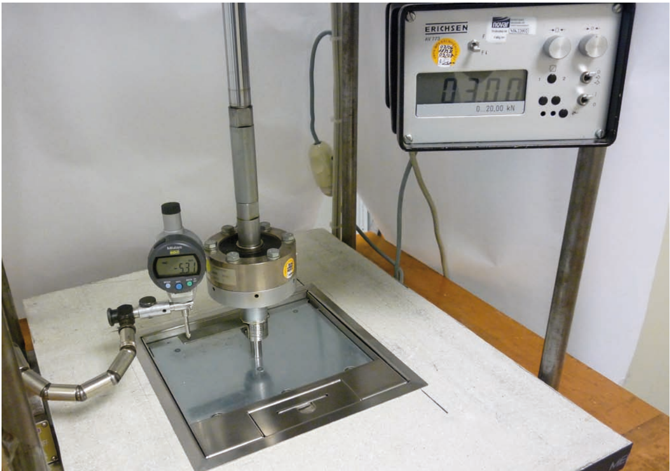
Bild 2: Belastungsprüfung eines Geräteeinsetzes Metall mit 3 kN und einer zulässigen Durchbiegung von weniger als 6 mm
