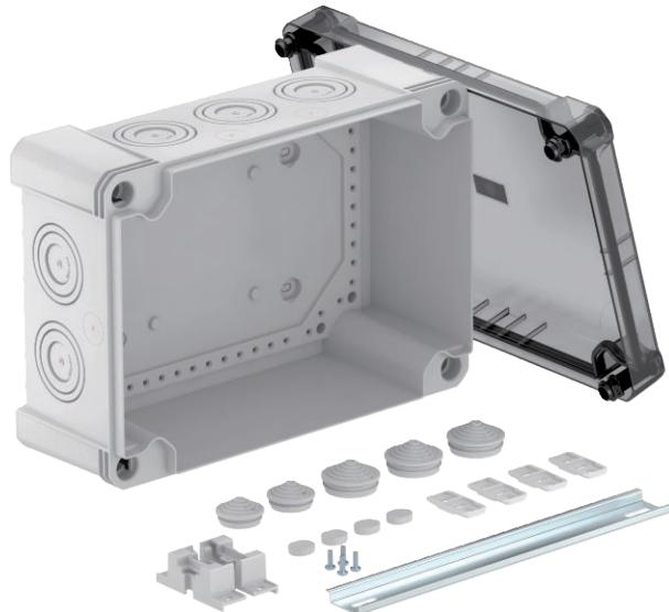
Kabelabzweigkasten mit Hutprofilschiene zum Verbinden von Kabeln und Leitungen im Innen- und Außenbereich. Rechteckige Form mit Ausschlageinführungen. Geeignet für die Wand-/Deckenmontage mit der Möglichkeit zur Außenbefestigung, Innenbefestigung oder Montage über die Eckdome. Besonders schlagfest mit IK08. Transparenter Deckel mit Schnellverschluss, plombierbar. Hergestellt aus halogenfreien und UV-beständigen Materialien. Inklusive Hutprofilschiene Typ 2069.
