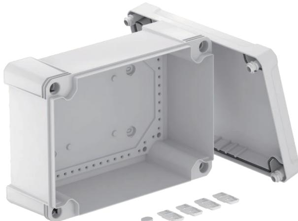
Kabelabzweigkasten zum Verbinden von Kabeln und Leitungen im Innen- und Außenbereich. Rechteckige Form ohne Einführungen. Geeignet für die Wand-/ Deckenmontage mit der Möglichkeit zur Außenbefestigung, Innenbefestigung oder Montage über die Eckdome. Besonders schlagfest mit IK08. Deckel mit Schnellverschluss, plombierbar. Hergestellt aus halogenfreien und UV-beständigen Materialien.
