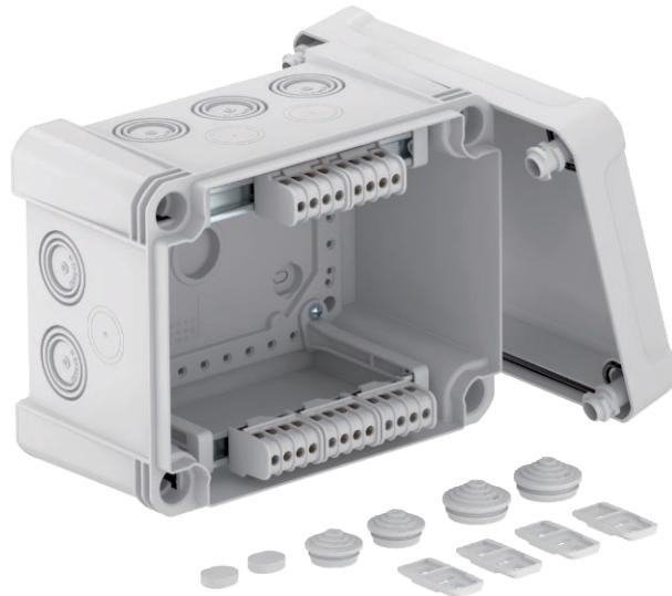
Kabelabzweigkasten mit Klemmleiste zum Verbinden von Kabeln und Leitungen im Innen- und Außenbereich. Rechteckige Form mit Ausschlageinführungen. Geeignet für die Wand-/Deckenmontage mit der Möglichkeit zur Außenbefestigung, Innenbefestigung oder Montage über die Eckdome. Besonders schlagfest mit IK09. Deckel mit Schnellverschluss, plombierbar. Hergestellt aus halogenfreien und UV-beständigen Materialien. Inklusive 5 Klemmleisten mit je 4 Klemmstellen.
