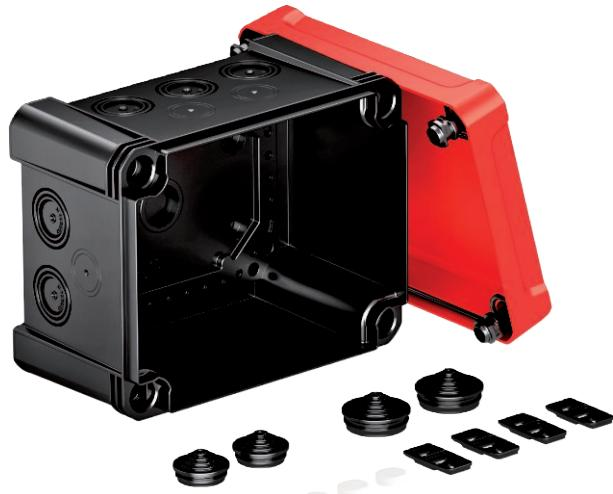
Kabelabzweigkasten zum Verbinden von Kabeln und Leitungen im Innen- und Außenbereich. Rechteckige Form mit Ausschlageinführungen. Geeignet für die Wand-/ Deckenmontage mit der Möglichkeit zur Außenbefestigung, Innenbefestigung oder Montage über die Eckdome. Besonders schlagfest mit IK09, Deckel mit Schnellverschluss, plombierbar. Hergestellt aus halogenfreien und UV-beständigen Materialien.
