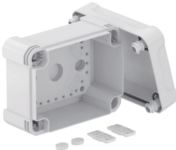
Kabelabzweigkasten zum Verbinden von Kabeln und Leitungen im Innen- und Außenbereich. Rechteckige Form ohne Einführungen. Geeignet für die Wand-/ Deckenmontage mit der Möglichkeit zur Außenbefestigung, Innenbefestigung oder Montage über die Eckdome. Besonders schlagfest mit IK08. Deckel mit Schnellverschluss, plombierbar. Hergestellt aus halogenfreien und UV-beständigen Materialien.
