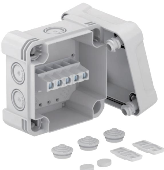
Kabelabzweigkasten mit Klemmleiste zum Verbinden von Kabeln und Leitungen im Innen- und Außenbereich. Quadratische Form mit Ausschlageinführungen. Geeignet für die Wand-/ Deckenmontage mit der Möglichkeit zur Außenbefestigung, Innenbefestigung oder Montage über die Eckdome. Besonders schlagfest mit IK09. Deckel mit Schnellverschluss, plombierbar. Hergestellt aus halogenfreien und UV-beständigen Materialien.
