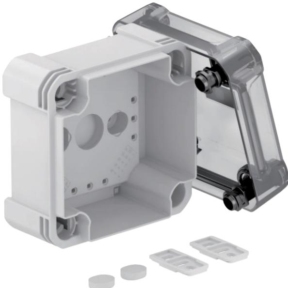
Kabelabzweigkasten zum Verbinden von Kabeln und Leitungen im Innen- und Außenbereich. Quadratische Form ohne Einführungen. Geeignet für die Wand-/ Deckenmontage mit der Möglichkeit zur Außenbefestigung, Innenbefestigung oder Montage über die Eckdome. Besonders schlagfest mit IK08. Transparenter Deckel mit Schnellverschluss, plombierbar. Hergestellt aus halogenfreien und UV-beständigen Materialien.
