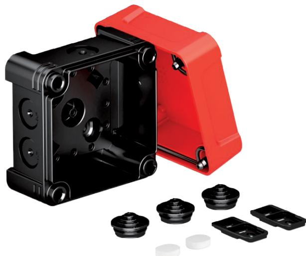
Kabelabzweigkasten zum Verbinden von Kabeln und Leitungen im Innen- und Außenbereich. Quadratische Form mit Ausschlageinführungen. Geeignet für die Wand-/ Deckenmontage mit der Möglichkeit zur Außenbefestigung, Innenbefestigung oder Montage über die Eckdome. Besonders schlagfest mit IK09, Deckel mit Schnellverschluss, plombierbar. Hergestellt aus halogenfreien und UV-beständigen Materialien.
