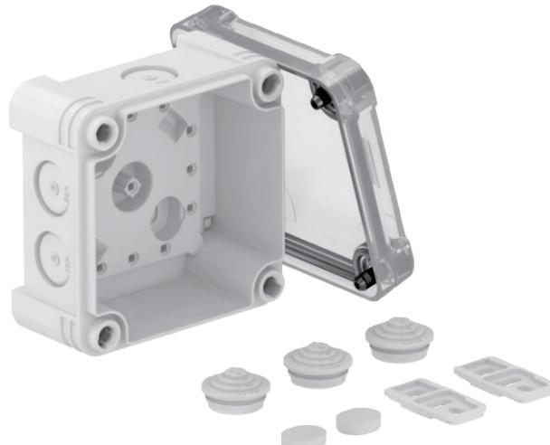
Kabelabzweigkasten zum Verbinden von Kabeln und Leitungen im Innen- und Außenbereich. Quadratische Form mit Ausschlageinführungen. Geeignet für die Wand-/ Deckenmontage mit der Möglichkeit zur Außenbefestigung, Innenbefestigung oder Montage über die Eckdome. Besonders schlagfest mit IK09, Transparenter Deckel mit Schnellverschluss, plombierbar. Hergestellt aus halogenfreien und UV-beständigen Materialien.
