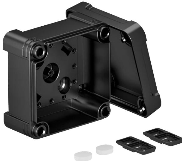
Kabelabzweigkasten zum Verbinden von Kabeln und Leitungen im Innen- und Außenbereich. Quadratische Form ohne Einführungen. Geeignet für die Wand-/ Deckenmontage mit der Möglichkeit zur Außenbefestigung, Innenbefestigung oder Montage über die Eckdome. Besonders schlagfest mit IK08. Deckel mit Schnellverschluss, plombierbar. Hergestellt aus halogenfreien und UV-beständigen Materialien.
