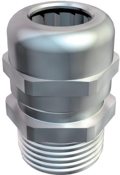
Robuste Kabelverschraubung mit metrischem Anschlussgewinde nach IEC 423 in Hutmutterbauart für hohe Dichtigkeitsansprüche. Zugentlastung, Verdrehschutz und Dichtigkeit über den gesamten Spannbereich. Für dickere Gehäusewandstärken in Verbindung mit Gegenmutter. Dichtring aus Neopren. Klemmeinsatz aus Polyamid. Mit vormontiertem Dichtring am Anschlussgewinde, VDE-geprüft nach DIN EN 50262, Schutzart IP68 bei 5 bar/1 h.
