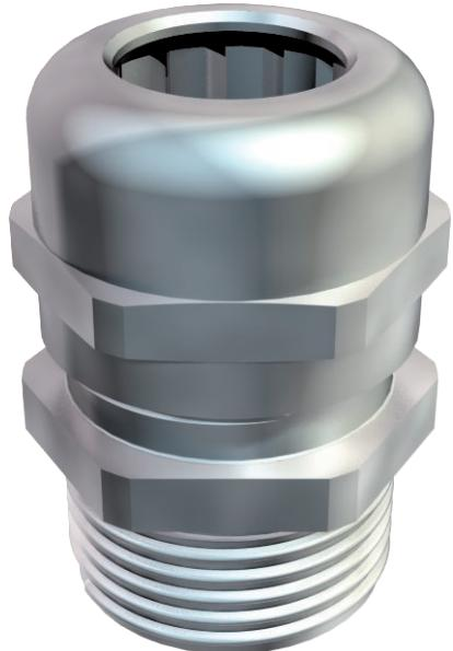
Robuste Kabelverschraubung mit metrischem Anschlussgewinde nach IEC 423 in Hutmutterbauart für hohe Dichtigkeitsansprüche. Zugentlastung, Verdrehschutz und Dichtigkeit über den gesamten Spannbereich. Für dickere Gehäusewandstärken in Verbindung mit Gegenmutter. Dichtring aus Neopren. Klemmeinsatz aus Polyamid. Mit vormontiertem Dichtring am Anschlussgewinde, VDE-geprüft nach DIN EN 50262, Schutzart IP68 bei 5 bar/1 h. Mit langem Anschlussgewinde.
