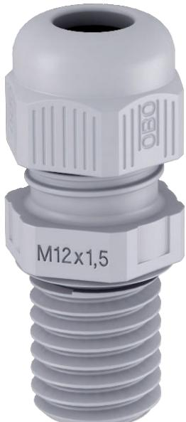
Kabelverschraubung mit metrischem Anschlussgewinde in Hutmutterbauart, für Kabelabzweigkästen, Gehäuse, Verteilerschränke im privaten und industriellen Bereich. Mit Zugentlastung und integrierter Dichtlippe, geprüft nach DIN EN 62444. Schutzklasse IP68. Einsetzbar von -20°C bis +65°C.
