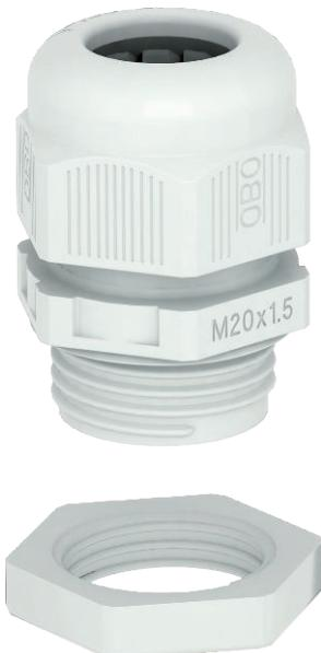
Kabelverschraubung mit metrischem Anschlussgewinde in Hutmutterbauart, für Kabelabzweigkästen, Gehäuse, Verteilerschränke im privaten und industriellen Bereich. Mit Zugentlastung und integrierter Dichtlippe, geprüft nach DIN EN 62444. Schutzklasse IP68. Einsetzbar von -20°C bis +65°C. Inklusive Gegenmutter.
