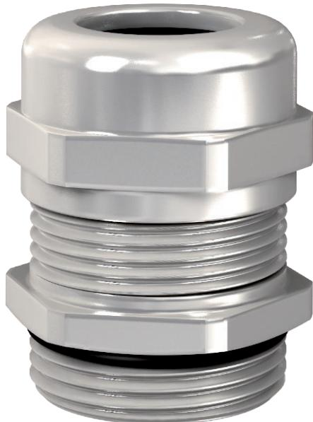
Robuste EMV Kabelverschraubung mit metrischem Anschlussgewinde nach IEC 423 in Hutmutterbauart für hohe Dichtigkeitsansprüche. Die Kontaktierung zwischen Verschraubung und Schirmgeflecht erfolgt über eine Kontaktfeder. Zugentlastung, Verdrehschutz und Dichtigkeit über den gesamten Spannbereich. Dichtring aus Neopren. Klemmeinsatz aus Polyamid. Mit vormontiertem O-Dichtring am Anschlussgewinde, VDE-geprüft nach DIN EN 50262, Schutzart IP68 bei 5 bar/1 h.
