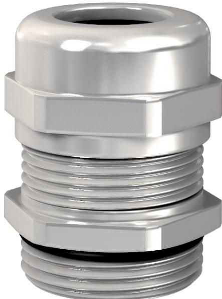
Robuste EMV Kabelverschraubung mit metrischem Anschlussgewinde nach IEC 423 in Hutmutterbauart für hohe Dichtigkeitsansprüche. Zugentlastung, Verdrehschutz und Dichtigkeit über den gesamten Spannbereich. Dichtring aus Neopren. Klemmeinsatz aus Polyamid. Mit vormontiertem O-Dichtring am Anschlussgewinde, VDE-geprüft nach DIN EN 50262, Schutztart IP68 bei 5 bar/1 h.
