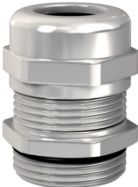
Robuste EMV Kabelverschraubung mit metrischem Anschlussgewinde nach IEC 423 in Hutmutterbauart für hohe Dichtigkeitsansprüche. Zugentlastung, Verdrehschutz und Dichtigkeit über den gesamten Spannbereich. Dichtring aus Neopren. Klemmeinsatz aus Polyamid. Mit vormontiertem O-Dichtring am Anschlussgewinde, VDE-geprüft nach DIN EN 50262, Schutzzart IP68 bei 5 bar/1 h.
