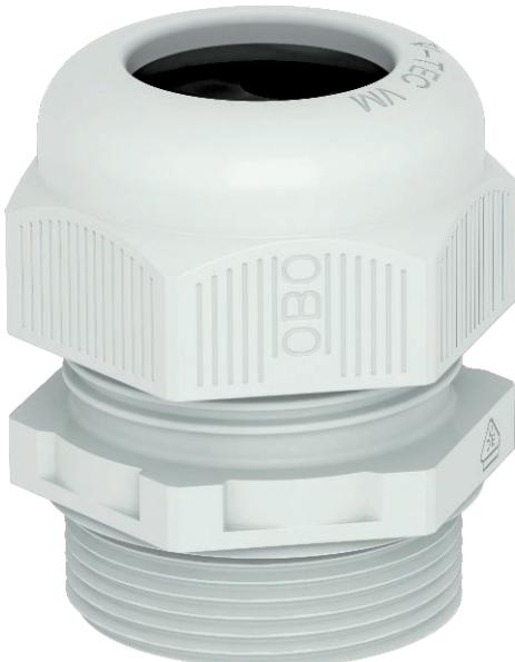
Kabelverschraubung mit metrischem Anschlussgewinde in Hutmutterbauart, für Kabelabzweigkästen, Gehäuse, Verteilerschränke im privaten und industriellen Bereich. Mit Zugentlastung und integrierter Dichtlippe, geprüft nach DIN EN 62444. Schutzklasse IP68. Einsetzbar von -20°C bis +65°C.
