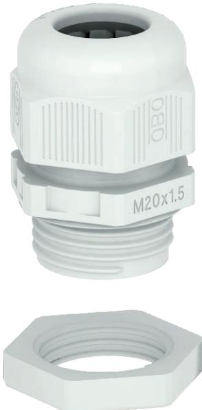
Die schnellste und bequemste Art mit Kabelverschraubungen an Kabelabzweigkästen und Gehäusen für Zugentlastung und Dichtigkeit zu sorgen: die bewährte V-TEC VM Kabelverschraubungen von OBO. Mit der integrierten Dichtlippe und speziellen OBO Lamellentechnik wird die Schutzklasse IP68 erreicht. Zugentlastung und Dichtigkeit sind geprüft nach DIN EN 62444.
