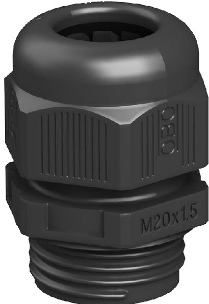
Die schnellste und bequemste Art mit Kabelverschraubungen an Kabelabzweigkästen und Gehäusen für Zugentlastung und Dichtigkeit zu sorgen: die bewährte V-TEC VM Kabelverschraubungen von OBO. Mit der integrierten Dichtlippe und speziellen OBO Lamellentechnik wird die Schutzklasse IP68 erreicht. Zugentlastung und Dichtigkeit sind geprüft nach DIN EN 62444.
