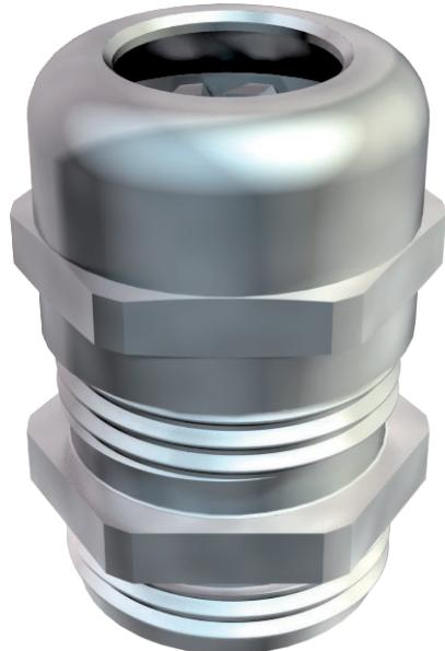
Kabelverschraubung in Hutmutterbauart mit großem Dichtbereich sowie Zugentlastung und Verdrehschutz für hohe Dichtigkeitsansprüche, mit PG-Anschlussgewinde nach DIN 40430. Klemmeinsatz aus Polyamid, Dichtring aus Chloroprene-Nitrilkautschuk, mit vormontiertem O-Ring am Anschlussgewinde. Schutzart IP68 bei 5 bar/1 h, geprüft nach VDE 0619. Anschlussgewindelänge „normal“, in Anlehnung an DIN 46320.
