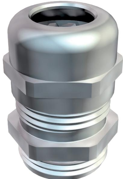
Kabelverschraubung in Hutmutterbauart mit großem Dichtbereich sowie Zugentlastung und Verdrehschutz für hohe Dichtigkeitsansprüche, mit PG-Anschlussgewinde nach DIN 40430. Klemmeinsatz aus Polyamid, Dichtring aus Chloroprene-Nitrilkautschuk, mit vormontiertem O-Ring am Anschlussgewinde. Schutzart IP68 bei 5 bar/1 h, geprüft nach VDE 0619. Anschlussgewindelänge „normal“, in Anlehnung an DIN 46320.
