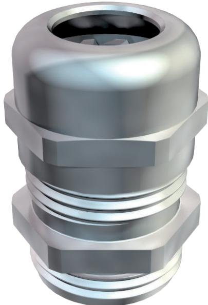
Kabelverschreibung in Hutmutternbauart mit großem Dichtbereich sowie Zugentlastung und Verdrehschutz für hohe Dichtigkeitsansprüche, mit PG-Anschlussgewinde nach DIN 40430. Klemmeinsatz aus Polyamid, Dichtring aus Chloroprene-Nitrilkautschuk, mit vormontiertem O-Ring am Anschlussgewinde.
