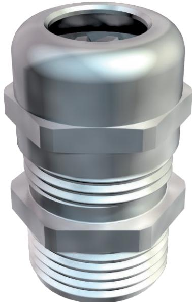
Kabelverschraubung in Hutmutterbauart mit großem Dichtbereich sowie Zugentlastung und Verdrehschutz für hohe Dichtigkeitsansprüche mit langem PG-Anschlussgewinde nach DIN 40430, für dickere Gehäusewandstärken in Verbindung mit Gegenmutter. Klemmeinsatz aus Polyamid. Dichtring aus Chloroprene-/Nitrilkautschuk. Am Anschlussgewinde vormontierter O-Ring. Schutzart IP68 bei 5 bar/1 h. Geprüft nach VDE 0619. Mit langem Anschlussgewinde.
