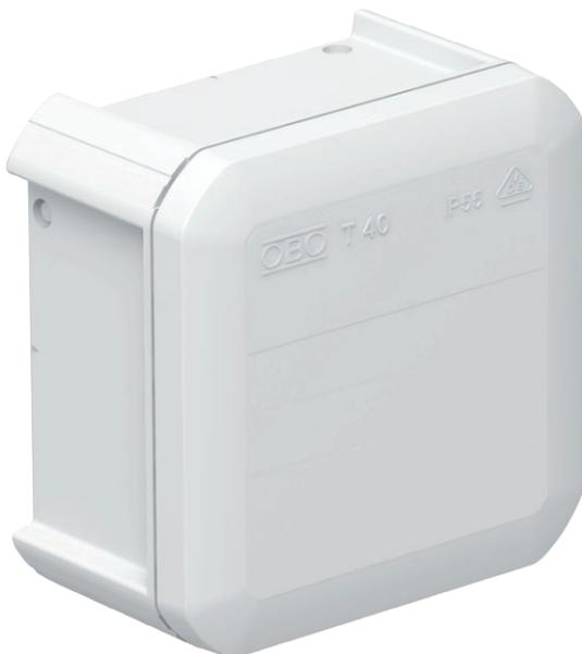
Kabelabzweigkasten zum Verbinden von Kabeln und Leitungen im Innenbereich und geschützten Außenbereichen. Quadratische Form ohne Einführungen. Geeignet für die Wand-/ Deckenmontage und die Montage auf Montageblechen. Mit der Möglichkeit zur Innenbefestigung und Montage über die Eckdome. Mit festsitzendem Klemmdeckel. Hergestellt aus halogenfreien Materialien. Kabelabzweigkasten gemäß DIN EN 60670. Flammwidrig nach DIN EN 60695-2-11, Prüftemperatur 650°C. Schlagfestigkeit IK07 gemäß DIN EN 50102.
