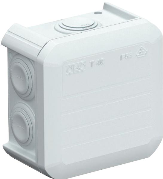
Kabelabzweigkasten zum Verbinden von Kabeln und Leitungen im Innenbereich und geschützten Außenbereichen. Quadratische Form mit Einstektdichtungen an den Seiten und Ausschlageinführungen im Boden. Geeignet für die Wand-/ Deckenmontage und die Montage auf Montageblechen. Mit der Möglichkeit zur Innenbefestigung. Mit festsitzendem Klemmdeckel. Flammwidrige Ausführung aus speziellem Polypropylen.
