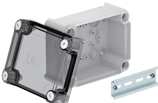
Kabelabzweigkasten geschlossen zum Verbinden von Kabeln und Leitungen im Innenbereich und geschützten Außenbereichen. Rechteckige Form ohne Einführungen. Geeignet für die Wand-/Deckenmontage und die Montage auf Montageblechen. Mit der Möglichkeit zur Innenbefestigung und Montage über die Eckdome. Hoher, transparenter Deckel mit Schnellverschluss, plombierbar. Hergestellt aus halogenfreien Materialien.
