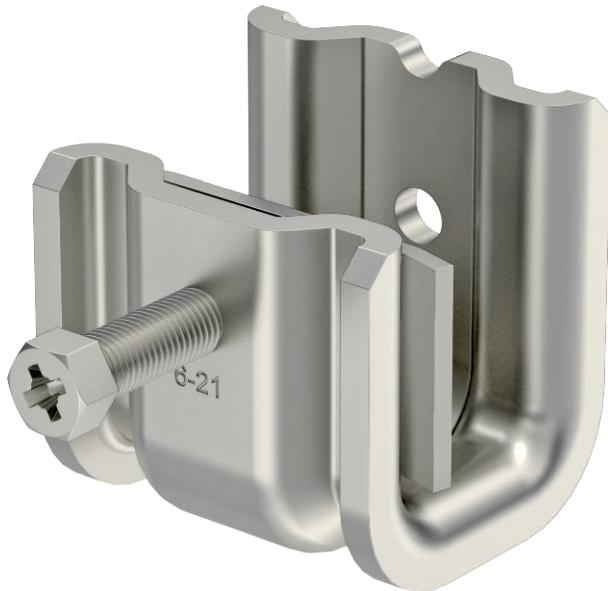
Diese Art Trägerklammer wird auf den Träger aufgeschoben und mittels einer Druckwanne und Schraube (M8) am Träger oder Flacheisen fixiert. Die Sechskantschraube hat eine Schlüsselweite von 10 mm. Im Schellenkörper sind außerdem zwei weitere M6 Gewinde eingebracht, um zum Beispiel Gewindestangen zu befestigen.
