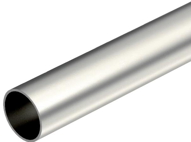
Elektroinstallationsrohr ohne Gewindestöpsel nach EN 61386-1, für den mechanischen Schutz von Kabeln und Leitungen. Mit grätfreier Innenwand. Korrosionsschutzklasse 4 (hoch). Klassifikation gemäß DIN EN 61386-1: 555711404010
