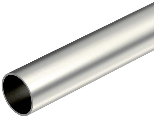
Elektroinstallationsrohr ohne Gewindeenden nach EN 61386-1, für den mechanischen Schutz von Kabeln und Leitungen. Mit gratfreier Innenwand. Korrosionsschutzklasse 4 (hoch). Klassifikation gemäß DIN EN 61386-1: 555711404010
