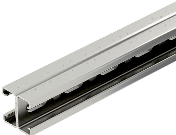
Profil-/Montageschiene mit durchgängiger Lochung im Boden in schwerer Ausführung und 22 mm Schlitzweite. In doppelter Ausführung, das heißt zwei Profilschienen sind am Boden miteinander verbunden (geschweißt).
