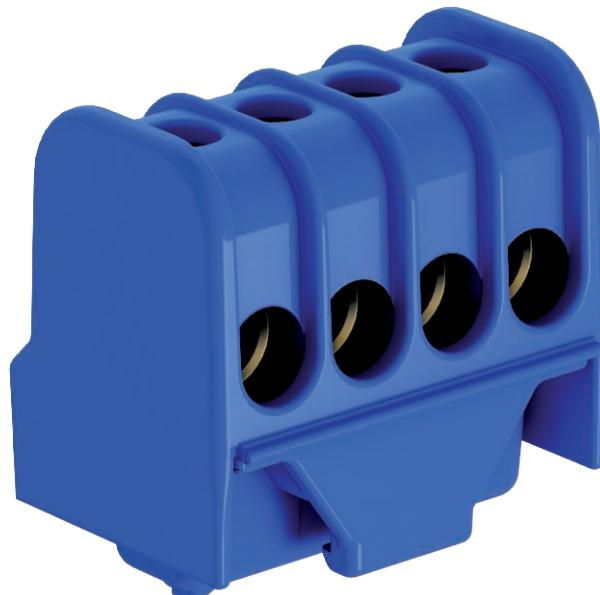
Neutralleiter-Anschlussklemme Messing, Schrauben Stahl, galvanisch verzinkt und transparent passiviert, Nennquerschnitt  $6 \div 16 \text{ mm}^2$ , Nennspannung 400 V, 1-polig, mit Buchsenklemmen max. anschließbare Leiter je Klemmstelle max.  $4 \times 16 \text{ mm}^2$ ,  $4 \times 10 \text{ mm}^2$ ,  $8 \times 6 \text{ mm}^2$  oder  $12 \times 4 \text{ mm}^2$ .
