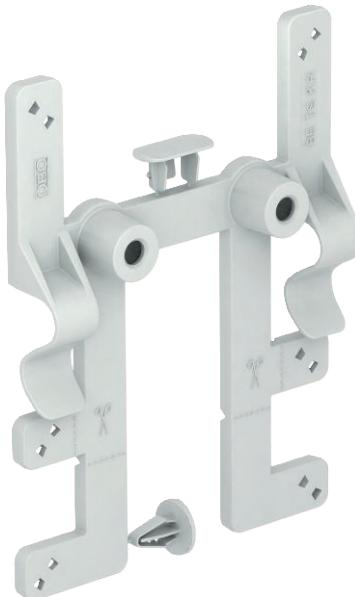
Mit dem Befestigungselement BE TS KR können OBO Kabelabzweigkästen Typ T60 und T100 mit wenigen Handgriffen werkzeuglos und schnell an allen gängigen Kabelrinnen angebracht werden. Dabei wird der Kabelabzweigkasten sicher in seiner Position gehalten. Er kann jedoch, falls erforderlich, schnell demontiert werden. Dies geschieht alles ohne die Verwendung von Werkzeug.
