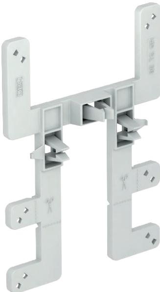
Mit dem Befestigungselement BE TS GR können OBO Kabelabzweigkästen Typ T60 und T100 mit wenigen Handgriffen werkzeuglos und schnell an Gitterrinnen angebracht werden. Dabei wird der Kabelabzweigkasten sicher in seiner Position gehalten. Er kann jedoch, falls erforderlich, schnell demontiert werden.
