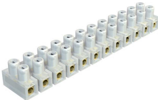
Klemmen Messing, vernickelt, Schrauben Stahl, galvanisch verzinkt und blau passiviert, 12-polige, in Einzelklemmen abtrennbar Leiste.
