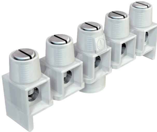
Klemmkörper Messing, vernickelt, Schrauben Stahl, galvanisch verzinkt und transparent passiviert, Nennquerschnitt 0,8 ÷ 2,5 mm<sup>2</sup>, Nennspannung 660 V, 5polig, mit Buchsenklemmen, max. anschließbare Querschnitte je Klemmstelle: 4 x 2,5 mm<sup>2</sup>, 5 x 1,5 mm<sup>2</sup> oder 6 x 1 mm<sup>2</sup>, nicht benötigte Pole können abgetrennt und als Einzelklemme verwendet werden.
