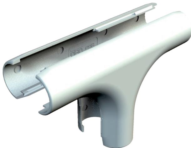
Formteil für Elektroinstallationsrohre aus Kunststoff zum Erstellen von T-Abzweigen. Geeignet für Rohr Quick-Pipe oder Wellrohre. Werkzeugloses Verschließen und Öffnen. Einsetzbar im Temperaturbereich von - 25° bis + 60° C.
