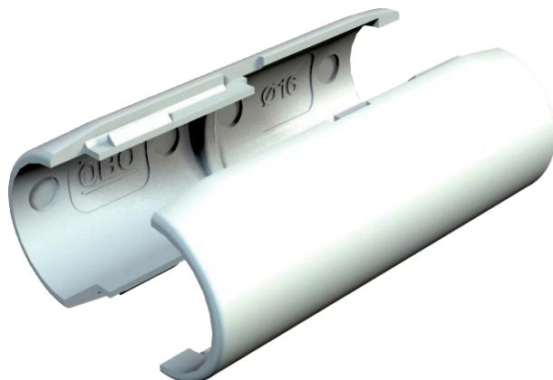
Verbindungs muf fe für Elektroinstallationsrohre aus Kunststoff zum Erstellen von Längsverbindungen. Geeignet für Rohr Quick-Pipe oder Wellrohre. Werkzeugloses Verschließen und Öffnen. Einsetzbar im Temperaturbereich von -25° bis + 60° C.
