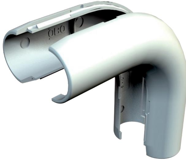
Formteil für Elektroinstallationsrohre aus Kunststoff zum Erstellen von 90°-Bögen. Geeignet für Rohr Quick-Pipe oder Wellrohre. Werkzeugloses Verschließen und Öffnen. Einsetzbar im Temperaturbereich von - 25° bis + 60° C.
