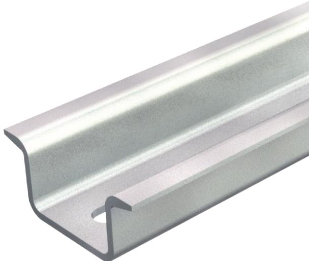
Hutprofilschiene 35 x 15 mm ähnlich DIN EN 60715 (früher DIN EN 50022), jedoch mit Materialstärke 1,5 mm.
