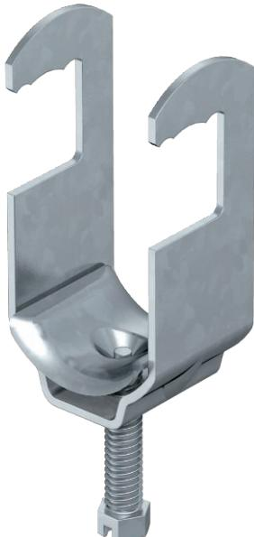
Passend zu allen Rundprofileisen bzw. Rohren mit Durchmesser bis 22 mm. Schelle, Druckwanne und Schraube aus Stahl sind tauchfeuerverzinkt.
