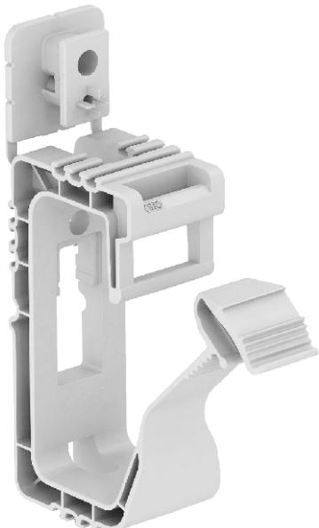
Sammelhalterung für die allgemeine Anwendung mit Befestigungslöchern 6 mm Ø, geeignet für Wand- und Deckenmontage. Das angespritzte Befestigungselement kann mit Schlagdübel oder Gasdrucknagelgerät befestigt werden. Der empfohlene Befestigungsabstand bei voller Belegung beträgt 50-60 cm.
