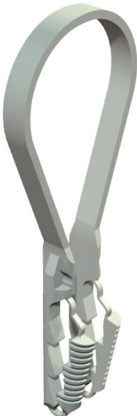
Für Leitungen, flexible Rohre und alle Arten von Isolier- und Panzerrohren, geeignet für Beton, Kalksandstein und Ziegelmauerwerk aus Vollstein. Eine Verwendung in Gasbetonmauerwerk ist möglich, jedoch muss mit einer Reduzierung der Tragfähigkeit gerechnet werden.
