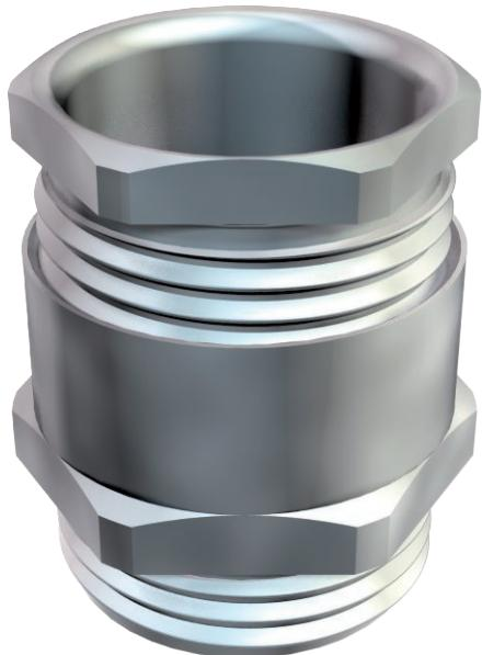
Kabelverschraubung mit Sechskant-Zwischenstutzen, Form C4 nach DIN 46320 mit metrischem Anschlussgewinde nach DIN EN 60423 bzw. ISO 68. Druckringe Stahl, galvanisch verzinkt und transparent passiviert. Dichtring aus NR/SBR.
