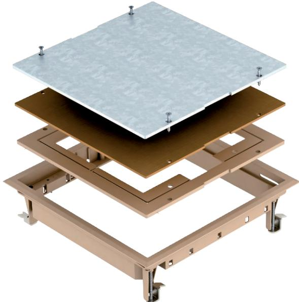
Zugdoseneinsatz zum Blindverschluss einer quadratischen Montageöffnung der Nenngröße 9 in einem Unterflur-System oder Doppelboden im Innenbereich. Teppichschutzrahmen aus Polyamid. Bodenbelagaussparung bei Lieferung auf 5 mm eingestellt, bei Bedarf auch einstellbar auf 3,8 oder 10 mm.
