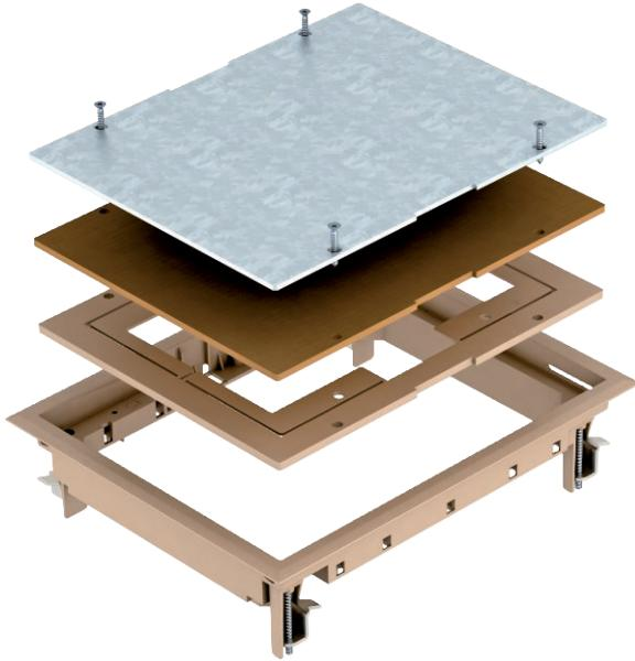
Zugdoseneinsatz zum Blindverschluss einer rechteckigen Montageöffnung der Nenngröße 6 in einem Unterflur-System oder Doppelboden im Innenbereich. Teppichschutzrahmen aus Polyamid. Bodenbelagaussparung bei Lieferung auf 5 mm eingestellt, bei Bedarf auch einstellbar auf 3, 8 oder 10 mm.
