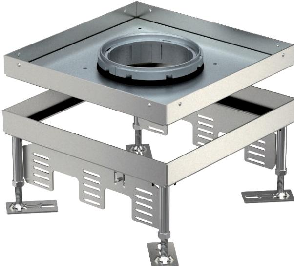
Quadratische Kassette Schwerlast für Tubus in Nenngröße 9 für den Einbau von Installationsgeräten in Kanalsystemen, Doppel- und Hohlböden, in trocken oder nass gepflegten Fußböden im Innenbereich. Belastungsklasse 1 bis 10 kN.
