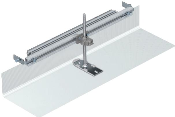
Montagefertiger Kanalendverschluss, bestehend aus einer flexiblen Schürze mit Seiten- und Bodenbelag anlegeprofilen. Im Lieferumfang enthalten sind Kanalverbindungswinkel und ein höhenstellbarer Befestigungswinkel.
