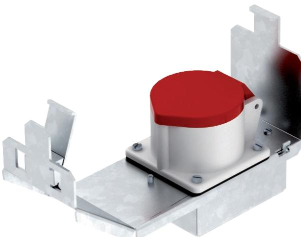
Geräteträger der Nenngroße 3 mit einer CEE-Steckverbindung 16 A zum Einbau in Geräteeinsätzen und Kassetten der Nenngroße R7, 9 und R9. Geräteträger mit Schutzgehäuse und Zugentlastung. Benötigte Mindesteinbautiefe: 190 mm bei Verwendung eines Geradeaus-Steckers und 160 mm bei Verwendung eines Winkelsteckers.
